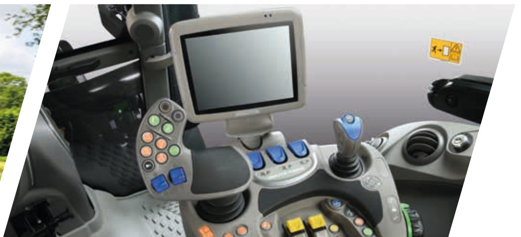
> Joystick MaxCom ergonómico con botones para la elevación, controles del motor/transmisión, botón de gestión de las cabeceras, dos distribuidores hidráulicos proporcionales y dos botones programables de libre asignación.
