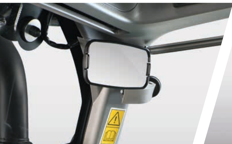
> Paquete de retrovisores internos para mejorar la visibilidad trasera.
