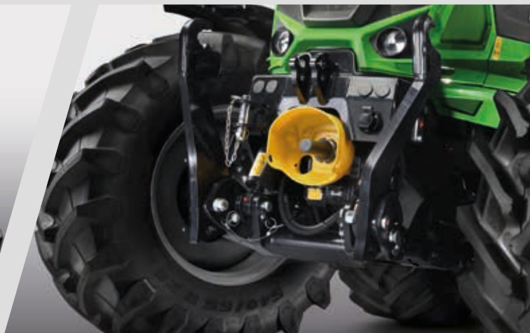
> Robusto elevador delantero con capacidad de elevación de 3000 Kg y TDF frontal integrada en los modelos 6130.4 - 6150.4.
