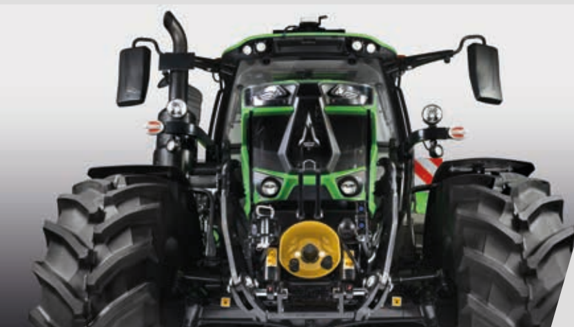
> Elevador delantero EFFICIENT con capacidad de elevación de 3800 Kg y TDF frontal integrada disponible en los modelos 6160.4 - 6170.4.
