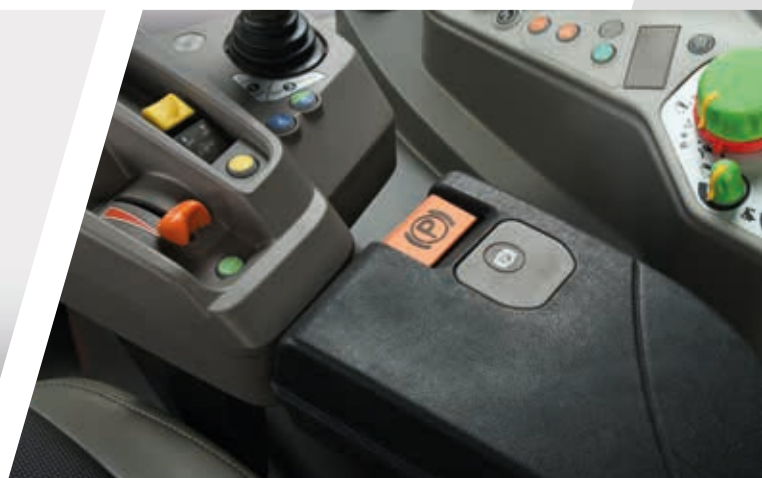
> Freno de estacionamiento electrónico (EPB) en los modelos RVshift y TTV.
