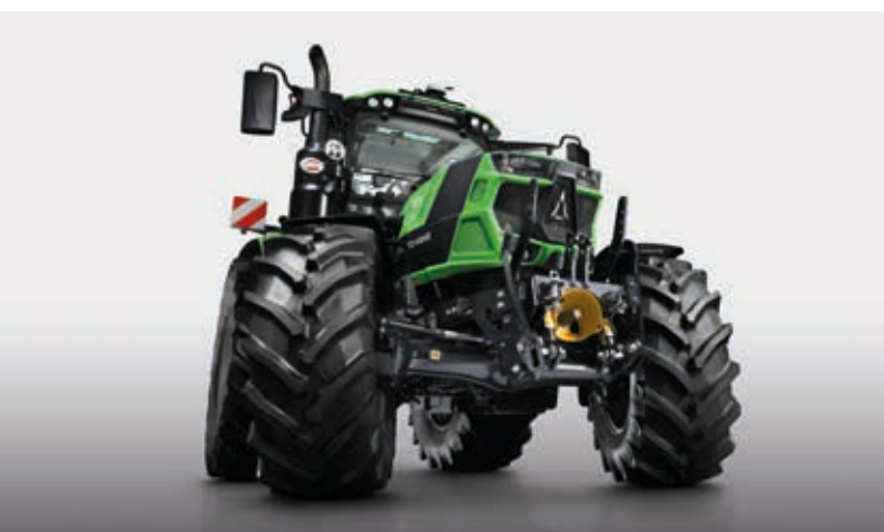
> Eje delantero suspendido con bloqueo del diferencial delantero al 100%.
